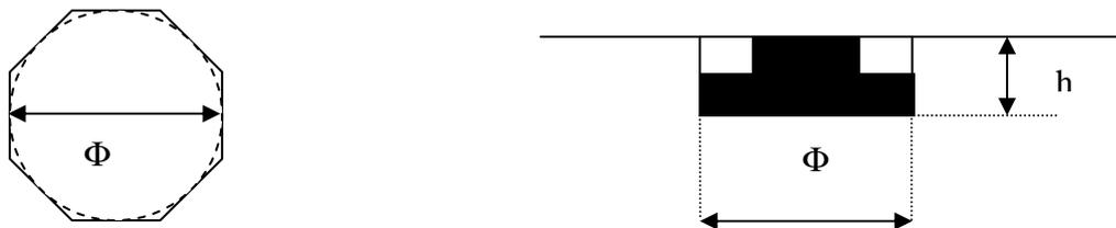
**Figure n° 14 : Massif de fondation d'éoliennes**
