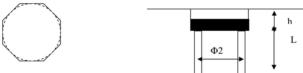
**Figure n° 25 : Schéma d'une semelle avec pieux.**
